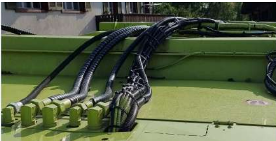
Bild: Öl- und Stromversorgung Fahrzeug der Kehrriechabfuhr
