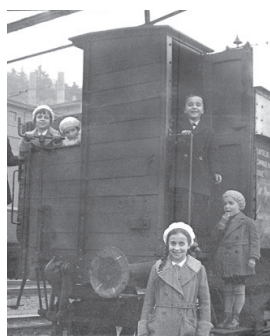
Güterwagen mit Bremserhäuschen und Handbremse, aufgenommen in Lausen, 1935. Bild Archiv Heinz Spinnler
